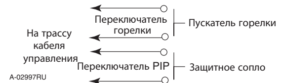
Схема цепи «детали на месте» для ручной горелки
